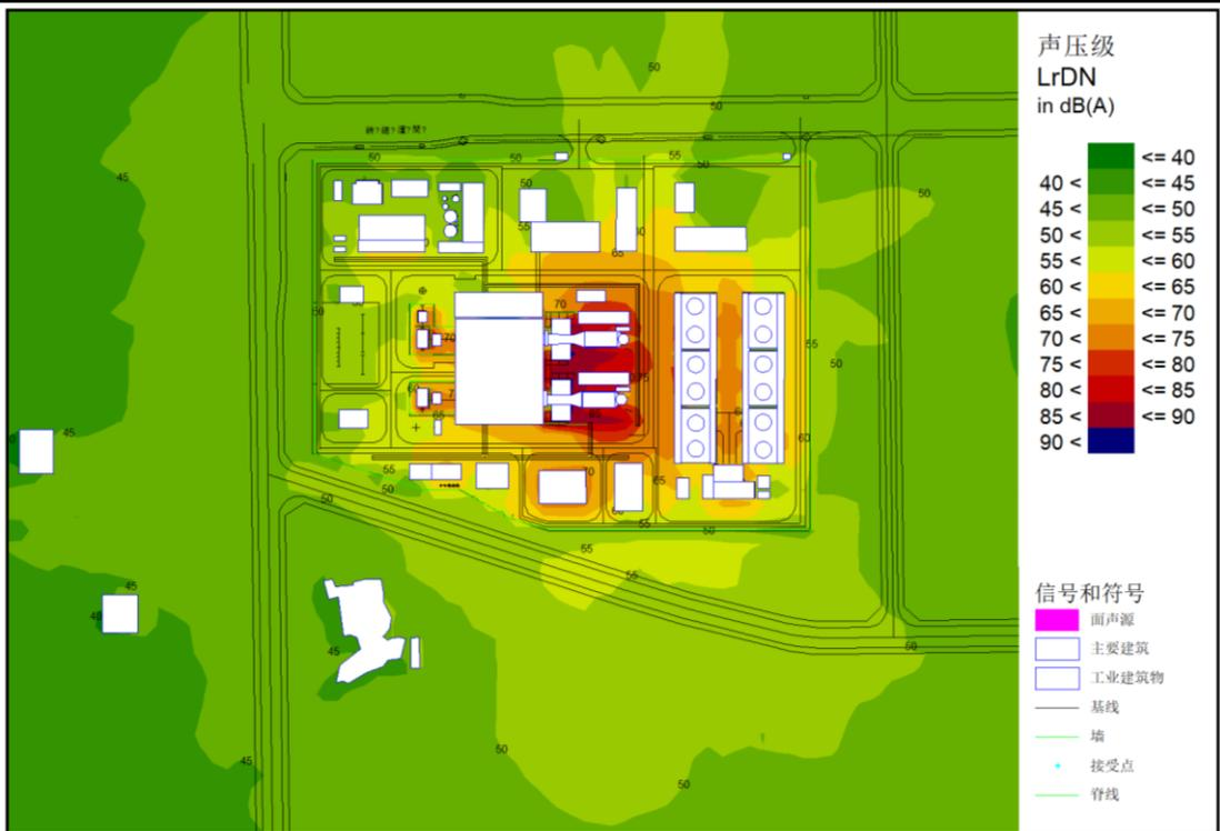
图 6 采取措施后噪声模拟图
