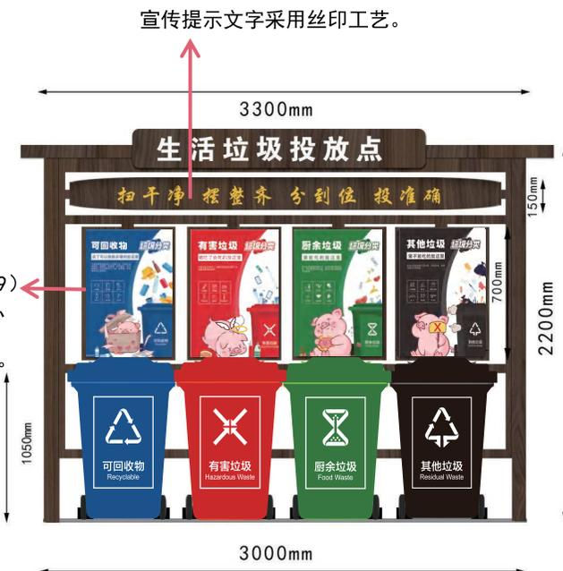
侧面宣传栏可根据实际需求定制画面。宣传栏底板采用镀锌板制作，画面采用亚克力UV喷印制作。
