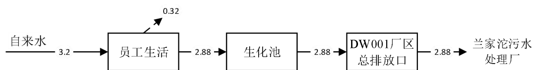
图 2.3-1 本项目水平衡图 单位 \text{m}^3/\text{d}
