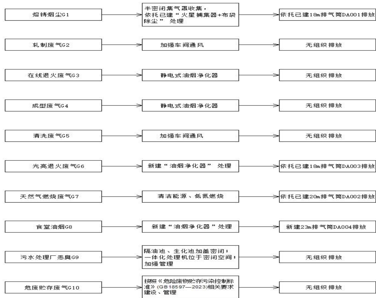
项目废气处理工艺示意图
